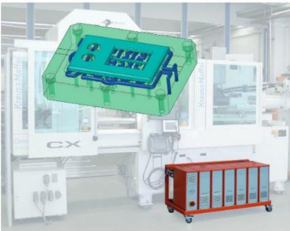
Bild 2: Ein wichtiger Einsparhebel bei der ZuPrEff-Versuchsanlage ist die Werkzeugtemperierung, die rund 47 Prozent der eingesetzten Energie benötigt (Bild: gwK)
