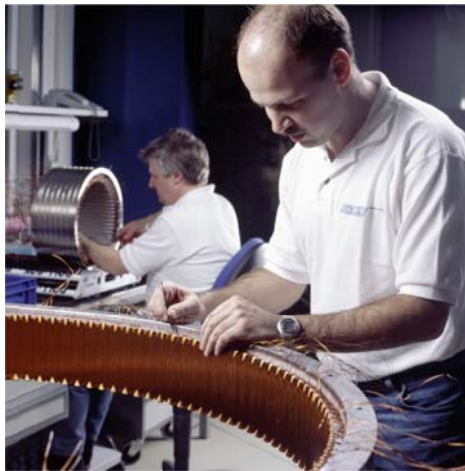
Herstellung von Elektromotoren mit Kupferdraht nach Stand der Technik Quelle: Schaeffler Technologies AG & Co. KG
